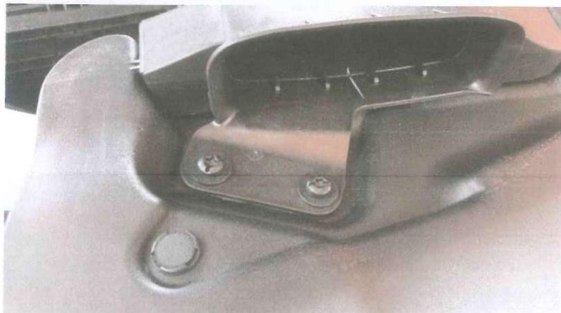
2/ Enlever les 2 vis du dessus à côté des optiques ainsi que les 2 vis tout en bas de l'optique
